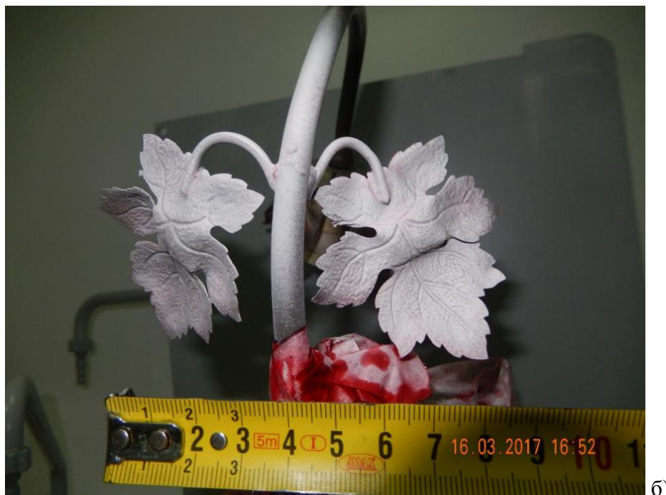
Сл. 6. Два корака у испитивању пенетрантима: а) после прскања црвеном суспензијом (други корак) и б) последњи (четврти) корак оваквог испитивања, (димензије су у сантиметрима)
