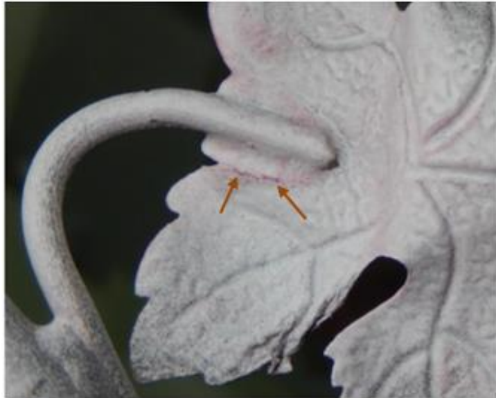
Сл. 7. Пенетрантима откривена пукотина (дужине \approx 6\text{mm} ) на месту лемљења, \approx \times 5
