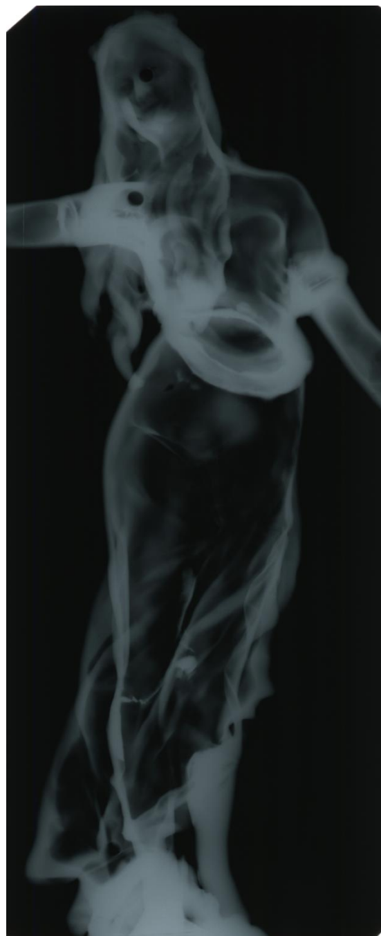
Сл. 3. Принцип рендгенског испитивања прозрачивањем а) и филм (негатив) целе стоне лампе б)
